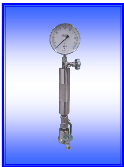
蒸気圧ポンベおよび圧力計
